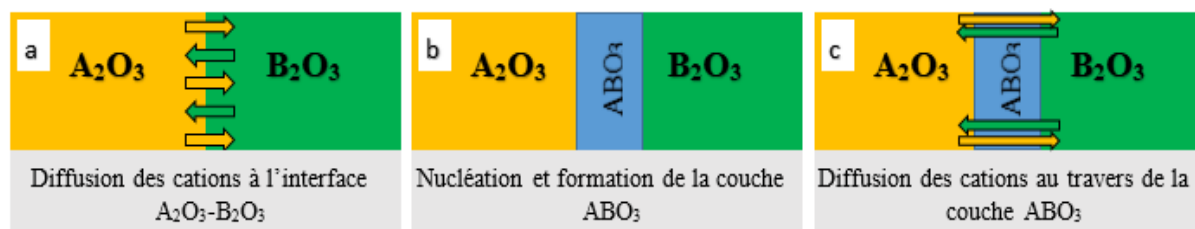
Figure II-1 Illustration du mécanisme réactionnel en voie solide lors de la formation d'une phase pérovskite \text{ABO}_3
