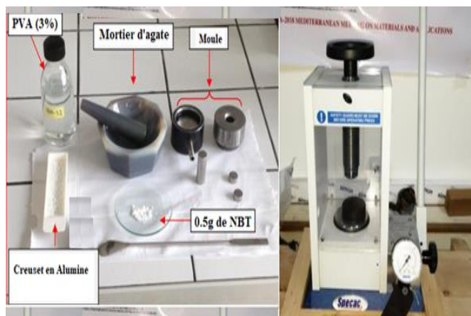
Figure III-7 Mise en forme des pastilles de (\text{Na}_{0,5}\text{Bi}_{0,5})\text{TiO}_3 pour le frittage classique. Le PVA-3% sert de liant organique
