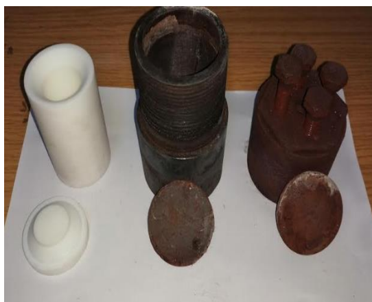
Figure II-5 Composants de l'autoclave utilisé en synthèse hydrothermale
