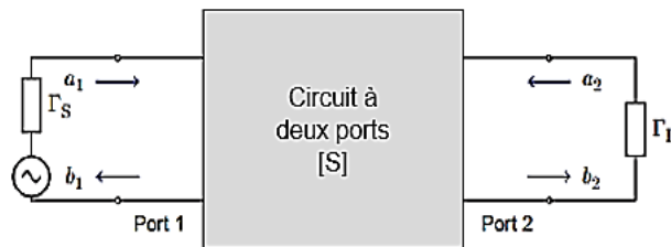
Figure 1. 13: Circuit à deux ports avec une source et une charge arbitraires
