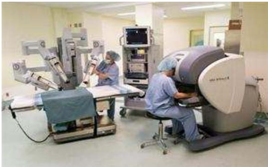
Figure 39 : Système da Vinci à quatre bras avec télémanipulateur [113]
