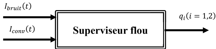
Figure 5.4. Superviseur flou proposé pour le calcul d'observateur FHGDF
