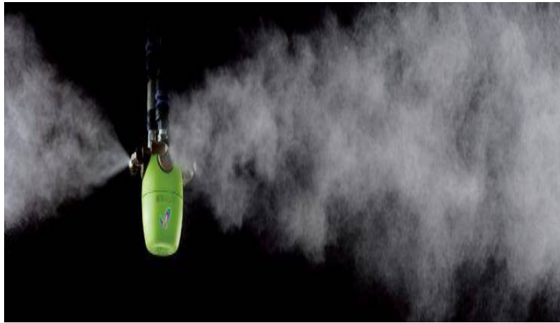
Figure 23 : Un système de brumisation à vapeur sèche permettant d'appliquer des désinfectants. [149]
