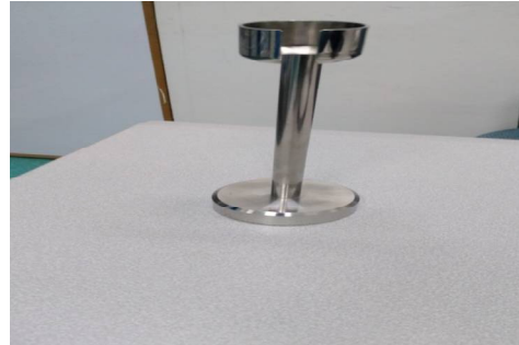
TREPIED MONTABLE : en inox, adapté pour porter ma sonde, avec position sur des surfaces horizontales
