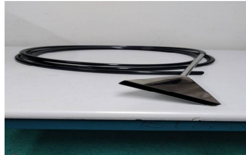
SONDE D'ECHANTILLONAGE : en inox, être dirigée vers le filtre HEPA lors de l'échantillonnage d'une zone à flux laminaire.
