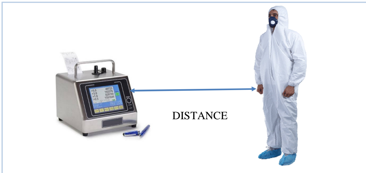
Figure 27 : Plan de prélèvement du comptage particulaire à différentes distances.
