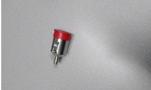
SONDE ISOCINETIQUE : en inox, lisse pour éviter l'adhérence des particules
