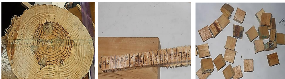
Fig.42. Eprouvettes EH et EId utilisées pour les mesures de l'humidité et d'infra-densité du bois.
