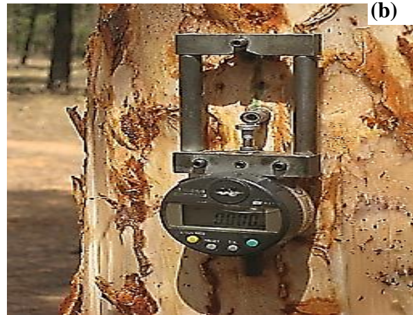
Bâti composé d'un châssis muni d'un comparateur.
