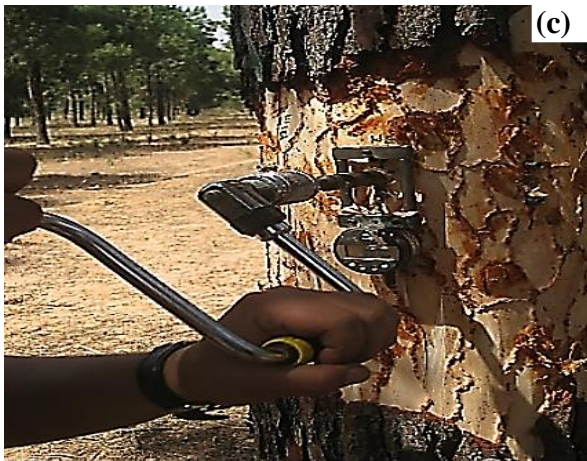
Perçage du trou de diamètre de 20 mm.
