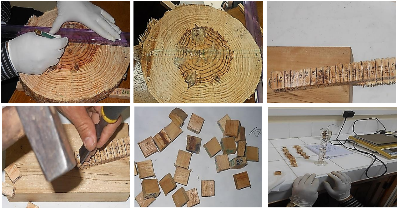
Fig.17. Étapes de prélèvement des éprouvettes EH et EID pour les mesures respectives des profils d'humidité, d'infra-densité et des différents retraits.
