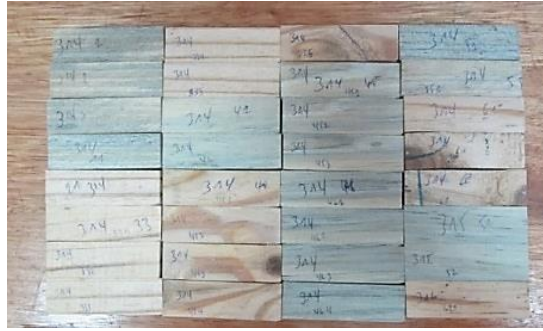
Fig.21. Epreuves Eméc soumises à la compression axiale.
