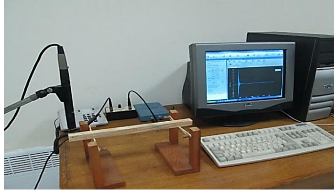
Fig.24. Illustration de l'essai vibratoire Bing.
