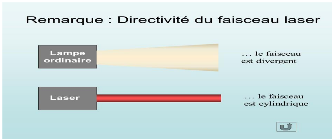
Figure 14 : le faisceau laser est cylindrique avec des rayons lumineux quasi-parallèles (31)
