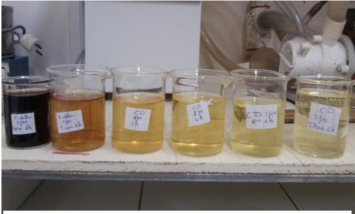
Figure VII.7 : Décoloration de l'échantillon au cours de traitement électrochimique
