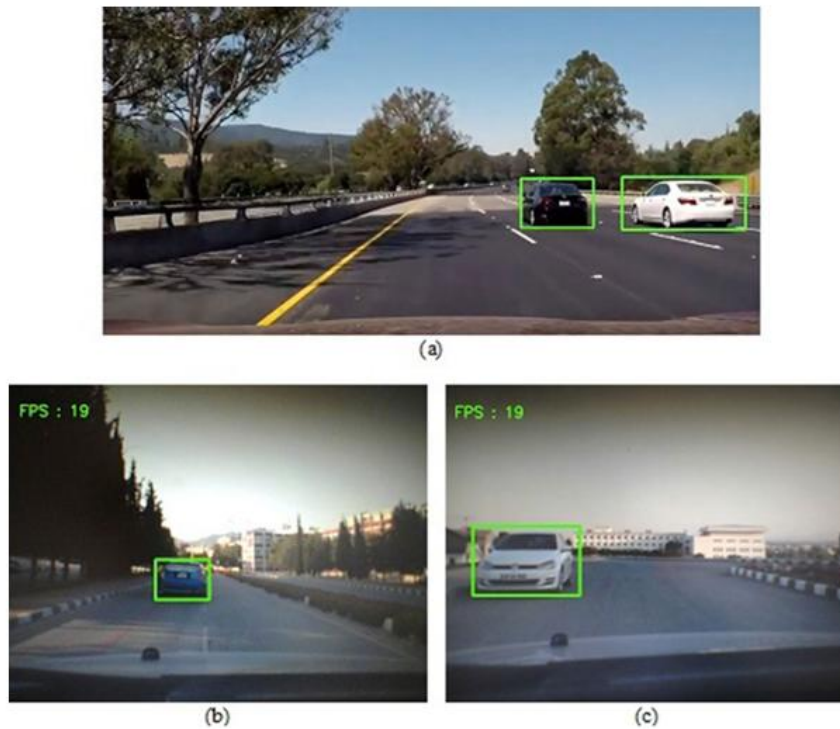
Figure 21 : Détection de véhicules basée sur les CNN pour la conduite automobile à partir de caméras vidéo [79]
