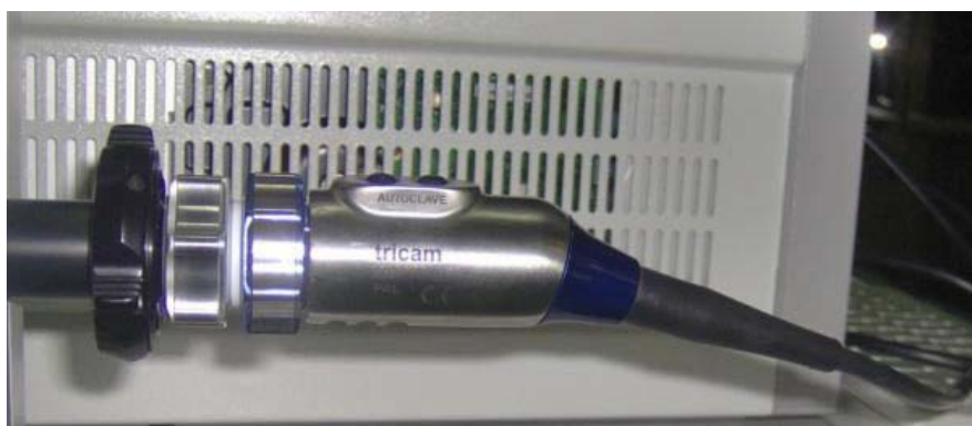
Figure 75 : La camera endoscopique reliant l'optique à la colonne vidéo [47]
