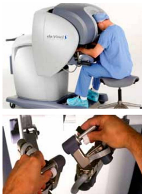
Figure 24 : Les mouvements réalisés par le chirurgien à la console de commande du robot sont miniaturisés et reproduits avec une précision extrême par les instruments chirurgicaux dans l'abdomen du patient.
