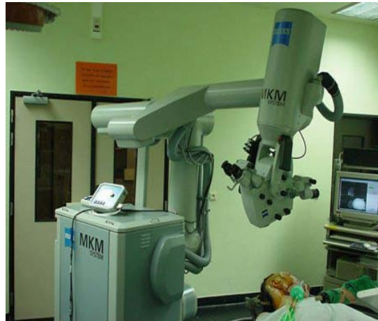
Figure 54: Progrès ultime de cette neuronavigation, le MKM est un robot multi-articulé sur lequel est monté un microscope opératoire performant qui se dirige automatiquement selon les trajectoires établies la veille.
