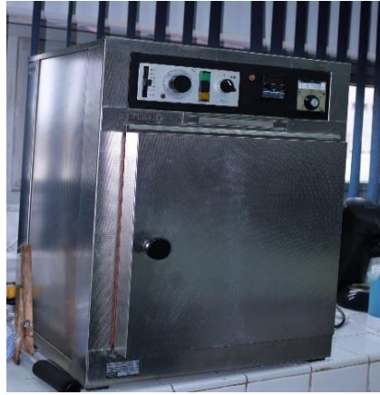
Figure 31 : Étuve pour séchage.
