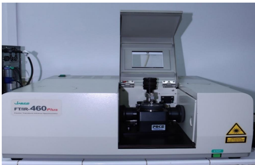
Figure 25 : Spectrophotomètre Jasco FT/IR-460Plus avec accessoires.
