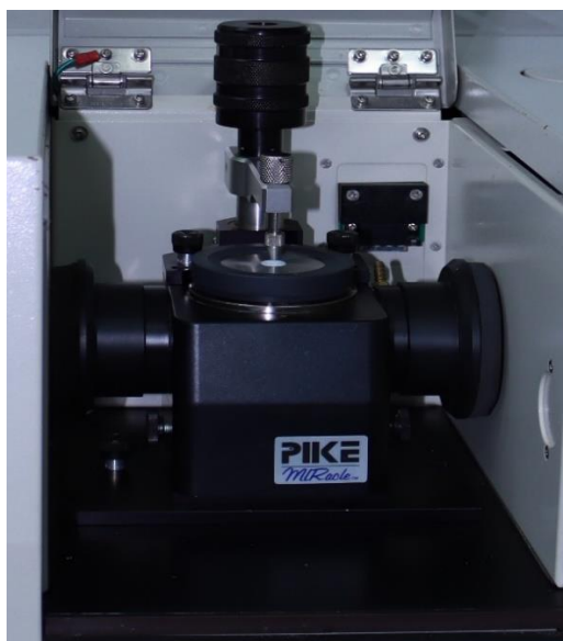
Figure 39 : Dispositif ATR d'un spectromètre Jasco FT/IR-460Plus (cristal en Germanium).
