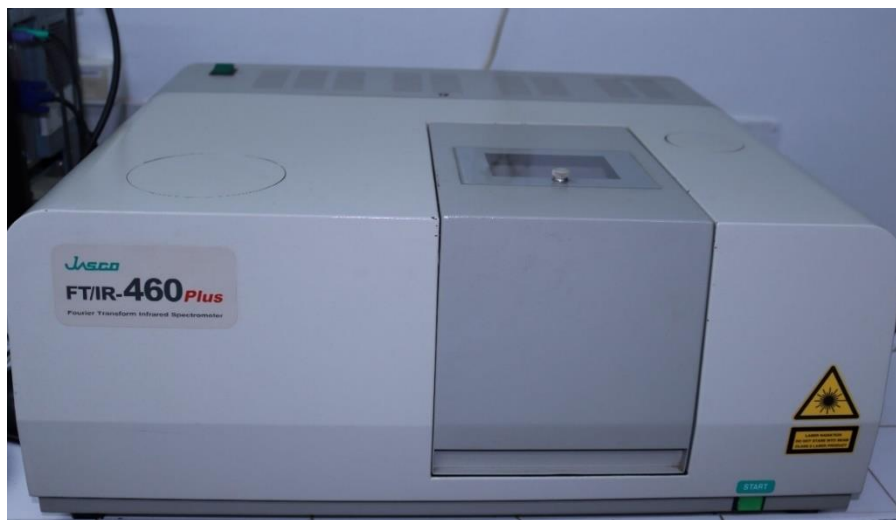
Figure 24 : Spectrophotomètre infrarouge à transformée de Fourier type Jasco FT/IR- 460Plus.
