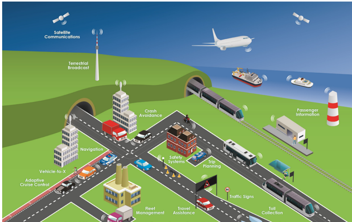
Figure 2.1 — Technologies et services de communication pour les STI [1]
