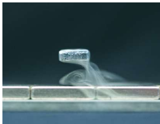
Figure 3.1. – Lévitation magnétique par effet Meissner
