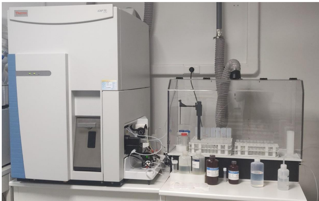
Figure 20: Spectromètre de masse à plasma (ICP-MS) utilisé pour l'analyse des métaux lourds dans l'eau de mer [106].
