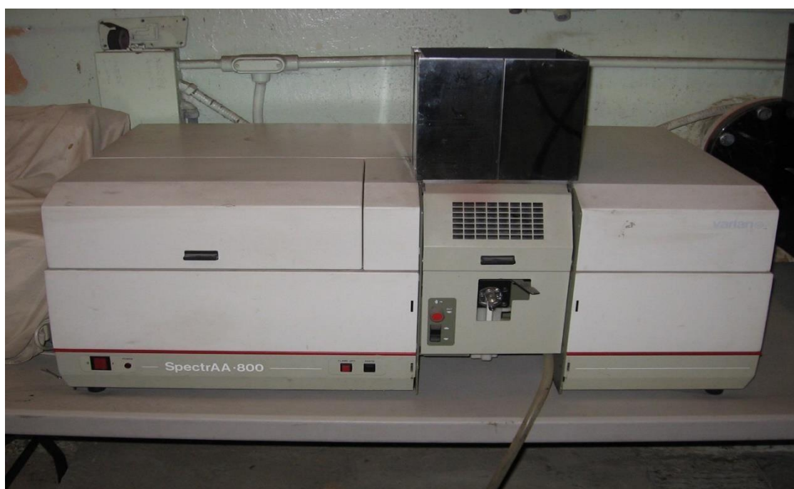
Figure 37: Spectromètre d'absorption atomique avec système hydride utilisé pour le dosage du mercure [106].
