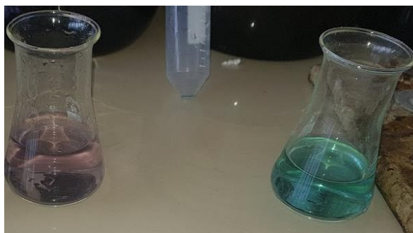
Figure 36 : Détermination \text{NH}_4\text{-N} et \text{NO}_3\text{-N} — Virage du vert à un violet pâle lors de la titration par \text{H}_2\text{SO}_4
