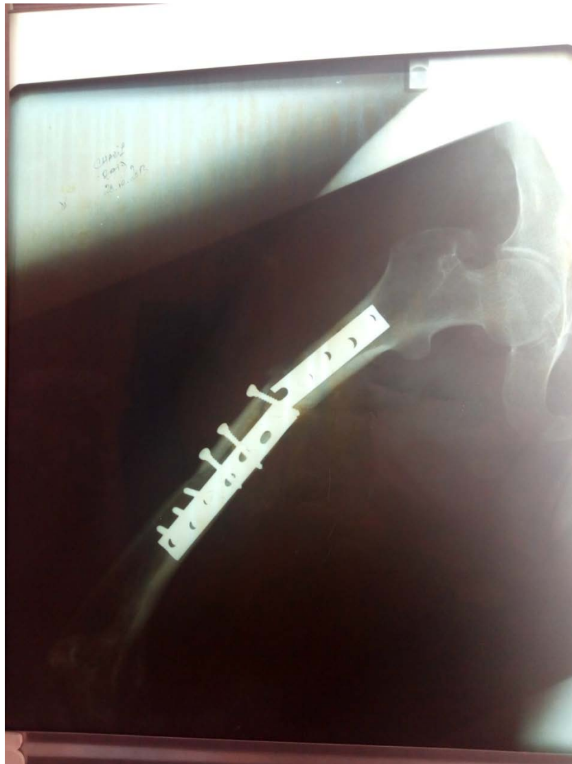
Cas N2 : Rupture de la plaque vissée du fémur
