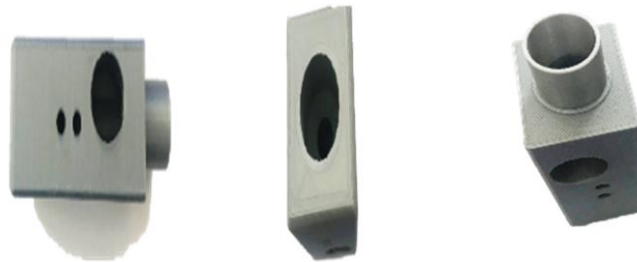
Figure 45 : Images de la chambre de Venturi montrant les orifices dans lesquelles les capteurs seront connectés.
