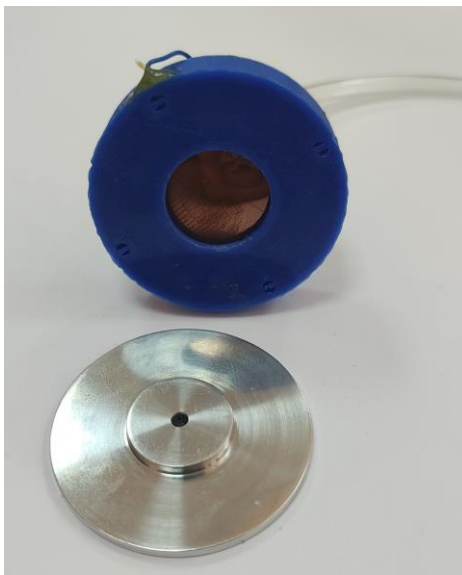
Figure 93 : Image du capteur réalisé. La partie bleue constitue la partie mobile du capteur, la partie réalisée en métal constitue la partie fixe avec d non uniforme.
