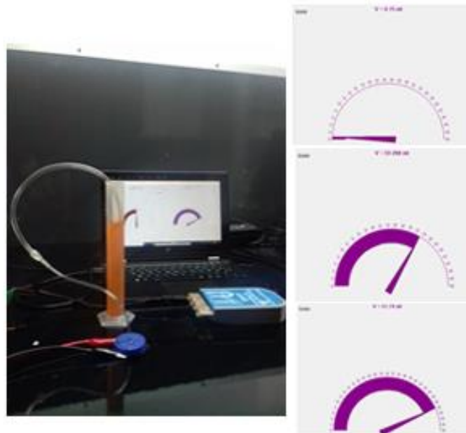
Figure 79 : Calcul de volume d'eau avec le capteur fabriqué [160], [161].
