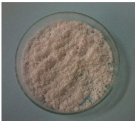
FIGURE 7.49: Sulfate de manganèse préparé par évapo-cristallisation MnSO_4 \cdot 2H_2O
