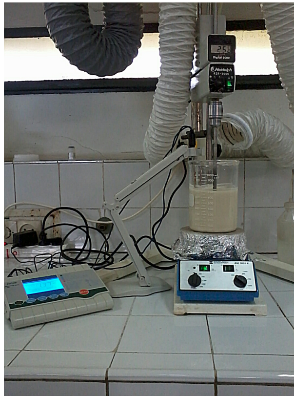
FIGURE 7.37: Essai de neutralisation du lixiviat par la chaux
