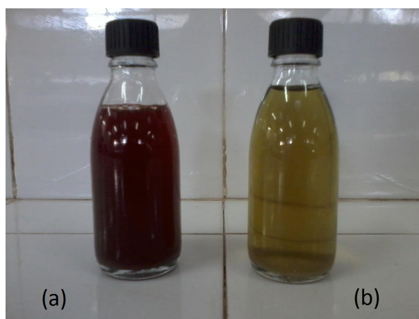
FIGURE 7.35: Solution des marges avant la réaction de lixiviation - agent lixiviant (a) ; Solution de lixiviation après la réaction de lixiviation - lixiviat (b)
