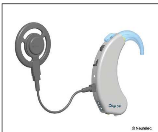
Figure 30 : Processeur Digisonic SP contour d'oreille connecté à son antenne.
