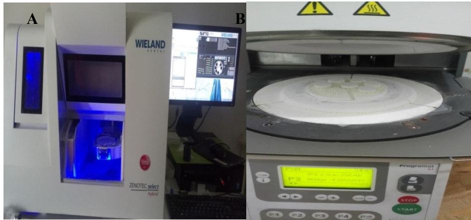
Figure II.1: A : Fraiseuse de CFAO à 5 axes portant un disque de zircone prêt à préparer des pastilles en 3D ; B : Four pour le frittage des pastilles obtenues par la CFAO à une température de 1450 °C.
