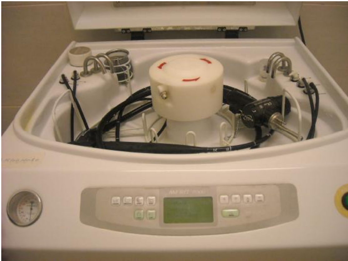
Figure 3 : Endoscope dans « un laveur désinfecteur » (Endoscope Washer Merit 9000) (Service de pédiatrie du CHU-Hassan II DE Fès).
