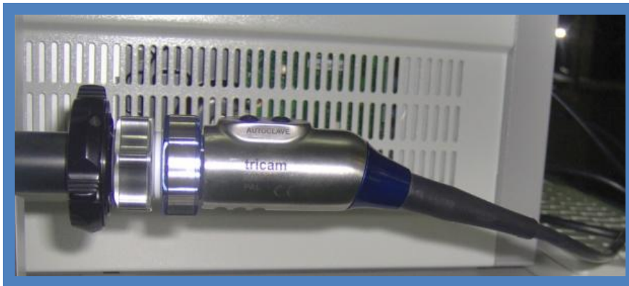
Image N°25: la camera endoscopique reliant l'optique à la colonne vidéo
