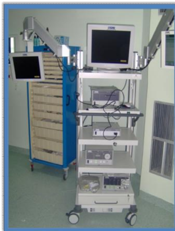
Image N°15: la colonne d'endoscopie avec la source de lumière et la vidéo
