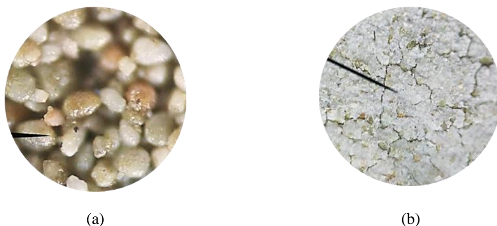
Figure 104 : Electrode de pâte phosphate naturel avant modification (a) et après modification par l'amoxicilline : 50 % poudre de carbone + 50% poudre d'amoxicilline (b)
