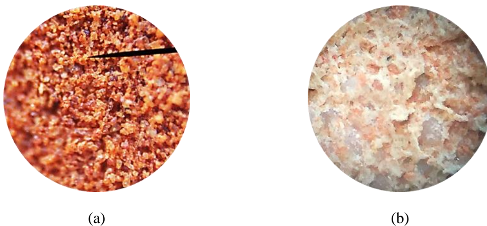
Figure 147 : Electrode de pâte d'argile avant modification (a) et après modification par l'amoxicilline : 50 % poudre de carbone + 50% poudre d'amoxicilline (b)
