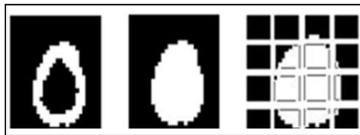
**Figure III.31:** Exemple d'extraction des primitives par la dilatation et le Zonage d'un caractère Tifinagh « yar »
