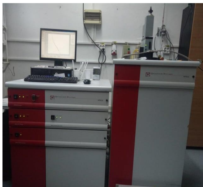
Figure II.17. Dispositif SQUID pour les mesures magnétiques.
