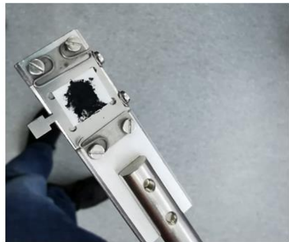
Figure II.10. Dispositif XPS (a) et le porte échantillon (b) utilisés pour l'analyse des échantillons.
