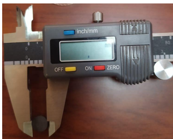
Figure. V.11. Pied à coulisse utilisé pour la mesure de dimensions des pastilles.
