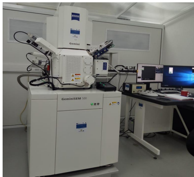
Figure II. 8. Dispositif MEB de type GeminiSEM 500 Carl Zeiss à haute résolution.
