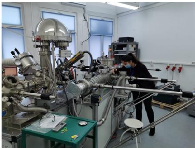
Figure II.10. Dispositif XPS (a) et le porte échantillon (b) utilisés pour l'analyse des échantillons.
