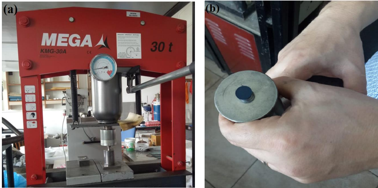
Figure II. 4. (a) Dispositif de pressage pour la formation des pastilles. (b) Photographie d'une pastille de la famille La_{1-x}A_xMnO_3 .
