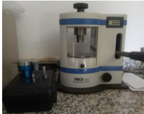
Figure V.8. Presse hydraulique CrushIR utilisé pour la préparation des pastilles La_{0,9}Na_{0,1}MnO_3 , La_{0,8}Na_{0,1}Pb_{0,1}MnO_3 , La_{0,9}Ka_{0,1}MnO_3 et La_{0,8}K_{0,1}Pb_{0,1}MnO_3 .
