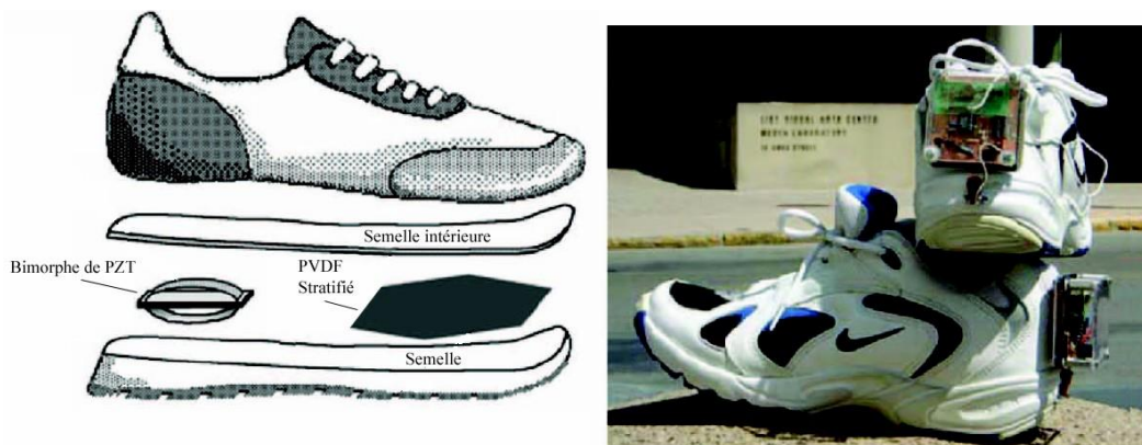
Figure 1.7 Chaussures piézoélectriques développées au MIT, utilisant soit du PVDF stratifié placé sous la plante du pied, soit un biomorphe réalisé à partir de céramiques piézoélectriques (PZT) placé sous le talon [20]
