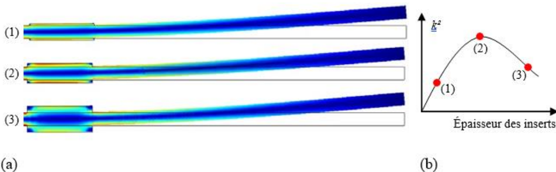
Figure 5.3 coefficient de couplage en fonction de l'épaisseur des inserts : (a) énergie élastique dans la structure pour trois épaisseurs différentes, (b) évolution typique du coefficient de couplage
