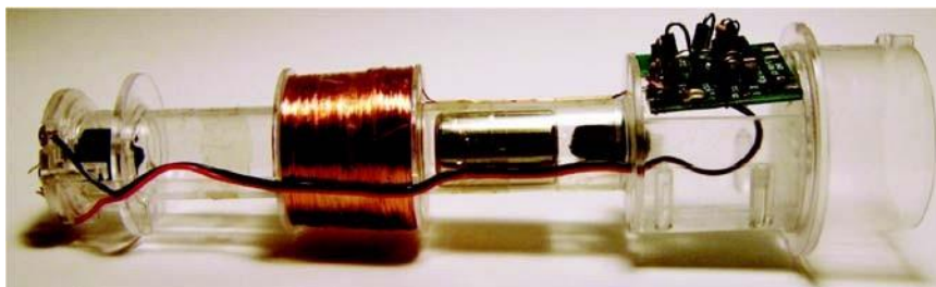
Figure 1.5 Lampe torche utilisant un générateur électromagnétique [19]
