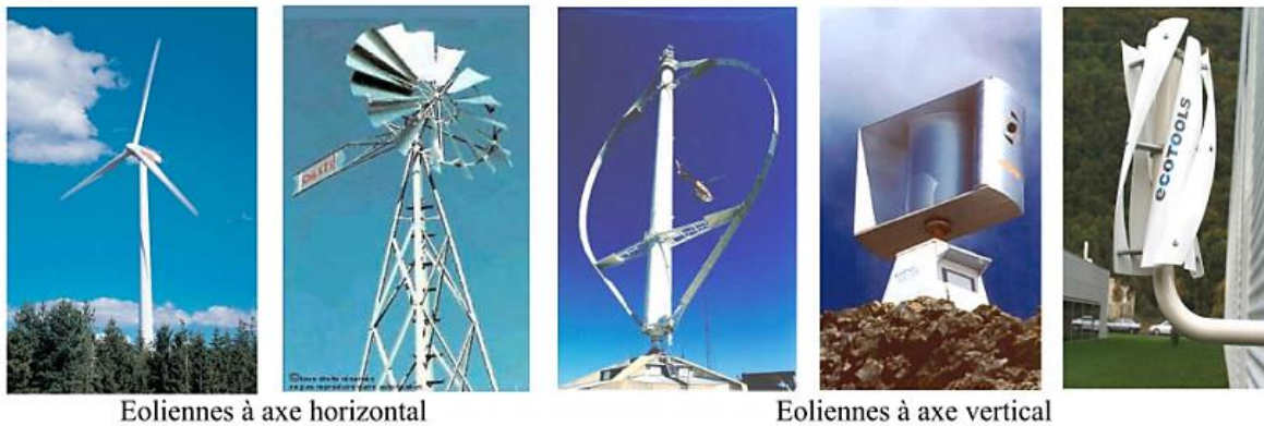
Figure 14: Turbines éoliennes à axe horizontal et à axe vertical
