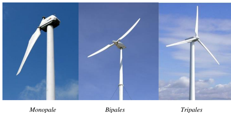
Figure 15: Turbines éoliennes monopale, bipales, tripales
