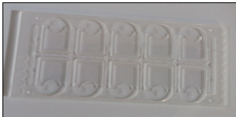
Figure 18: Grille de la cellule de Malassez
