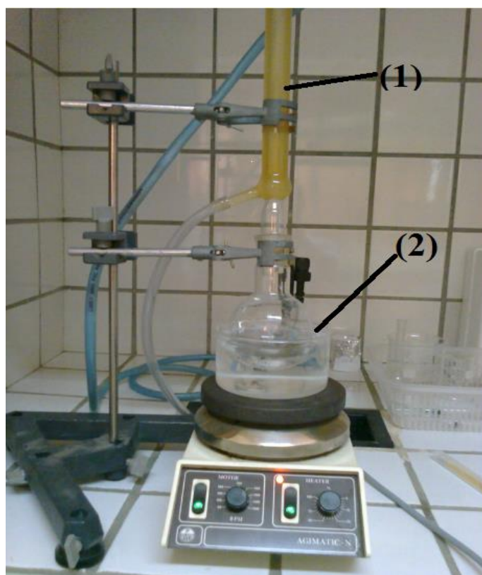
Figure III. 2 : Montage du chauffage à reflux
