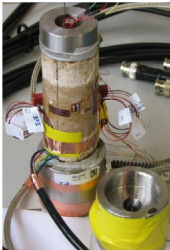
Figure 35. Dispositif de l'essai de compression uni-axiale (Eslami et al., 2009)
