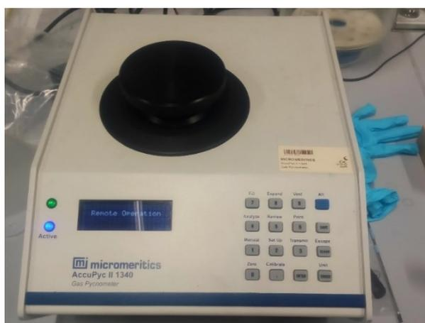
Figure 40: Le pycnomètre à hélium AccuPyc II 1340
