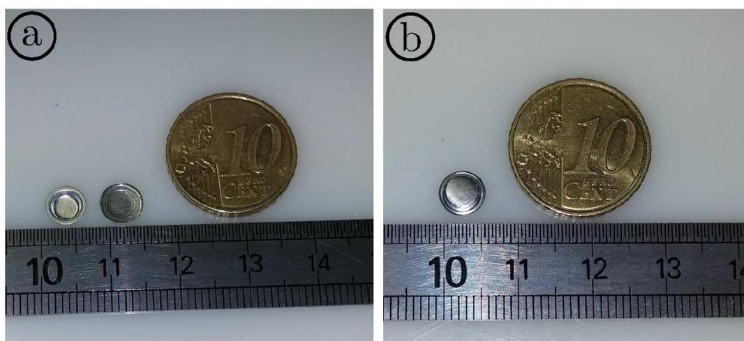
Figure 39: Photographie des cellules en aluminium 20  $\mu$ L Perkin-Elmer –
