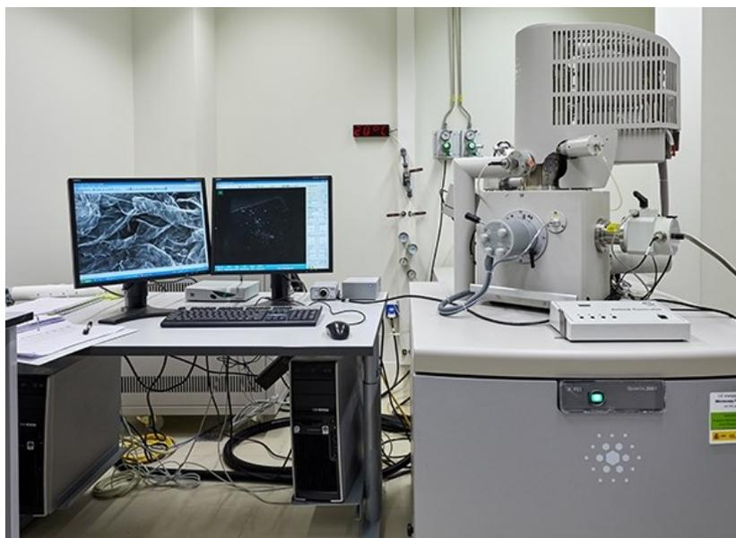
Figure 32: Microscope électronique à balayage (MEB) Quanta FEG 250.
