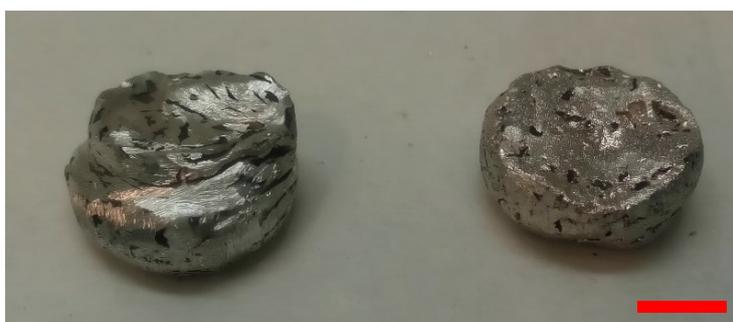
Figure 28: Des échantillons de l'alliage  $Mg_{84}Cu_{16}$  (à gauche) et  $Mg_{59}Cu_{41}$  (à droite)
