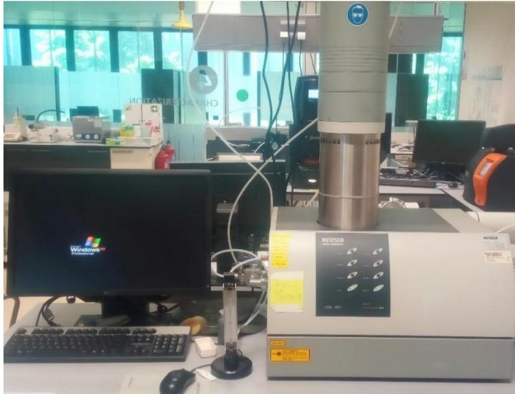
Figure 41: L'appareil de flash laser (LFA) (LFA 457 MicroFlash™ NETZSCH)
