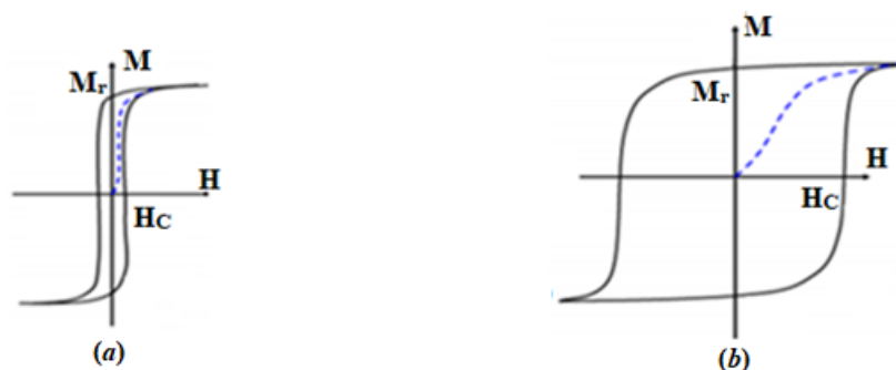
Figure I-3 : Représentation schématique des cycles d'hystérésis pour des matériaux ferromagnétiques doux (a) et durs (b).
