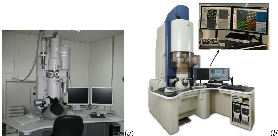
Figure II-7 : Photographies des METs utilisés ; celui du CNRS-UATRS (Rabat) (a) et celui du CC-3M de l'Institut Jean-Lamour (Nancy) (b).
