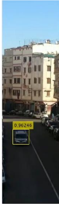
Figure 91. Détection de véhicules (Soustraction de l'arrière-plan basée sur le modèle de mélange gaussien)
