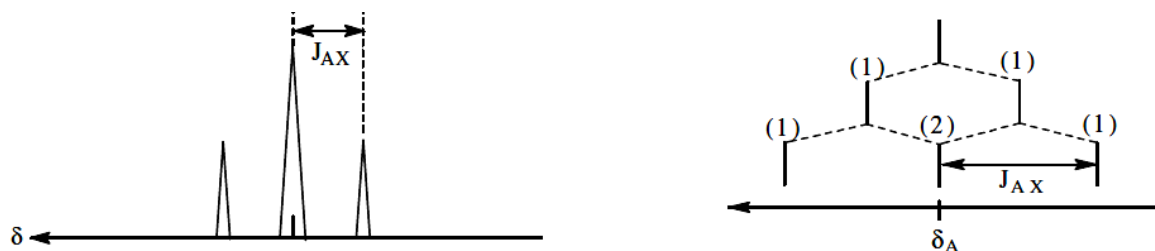
Figure II-11 : Représentation du spectre du proton A soumis simultanément au couplage des deux protons X.
