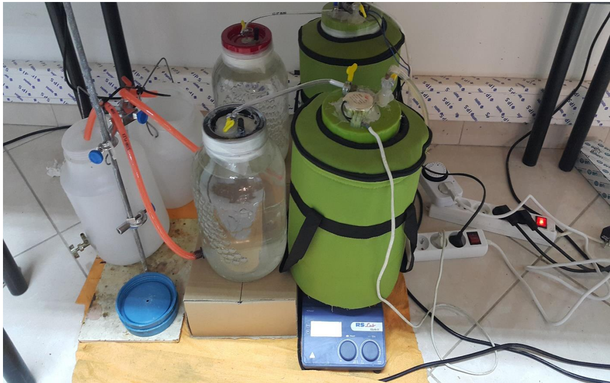
Figure 17: Montage final du procédé de digestion anaérobie.
