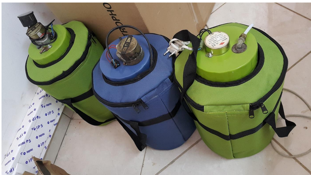
Figure 16: Les trois bioréacteurs fabriqués au laboratoire.
