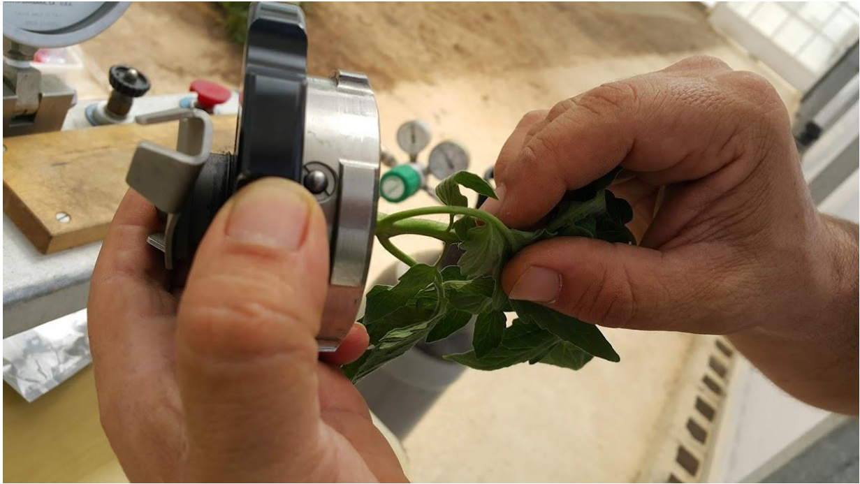
Figure 26: Attachement de l'appareil autour de la tige de la feuille de tomate.
