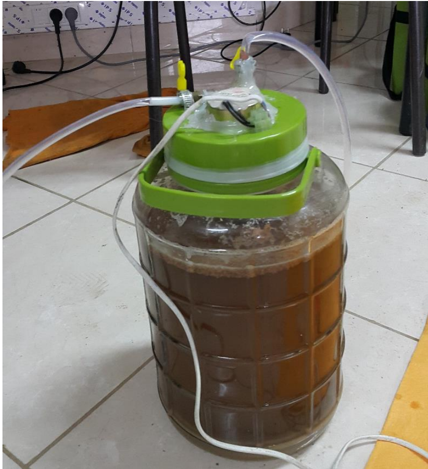
Figure 15: Bioréacteur rempli et prêt pour l'utilisation.
