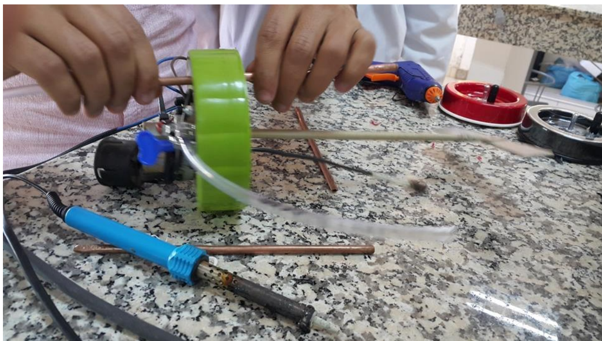
Figure 13: Insertion des ports d'échantillonnage, de sonde de température et de collecteur de biogaz.
