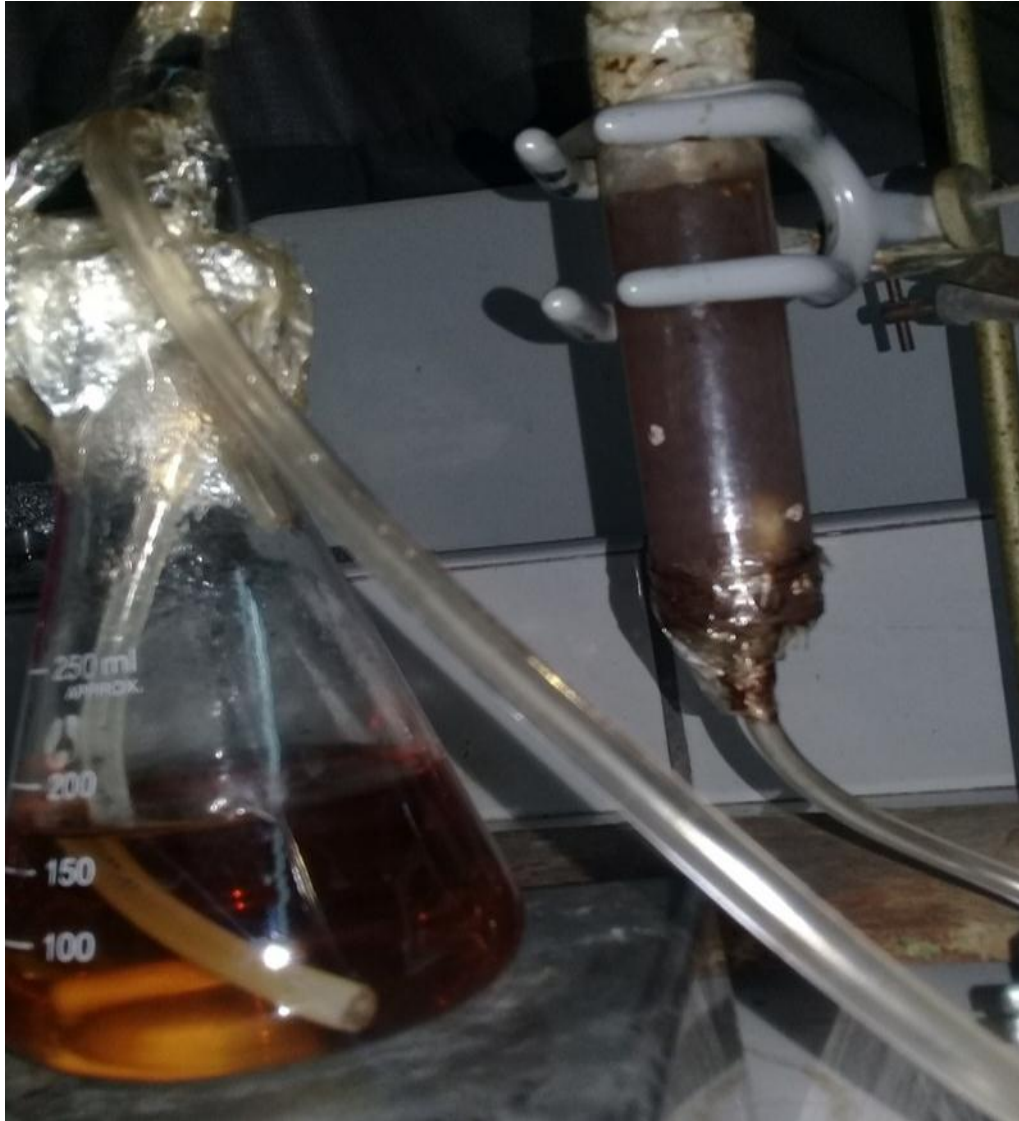
Figure IX-8: Photo illustre la perte de la texture des billes de AS/AP sous l'effet du nombre des cycliques d'adsorption/désorption
