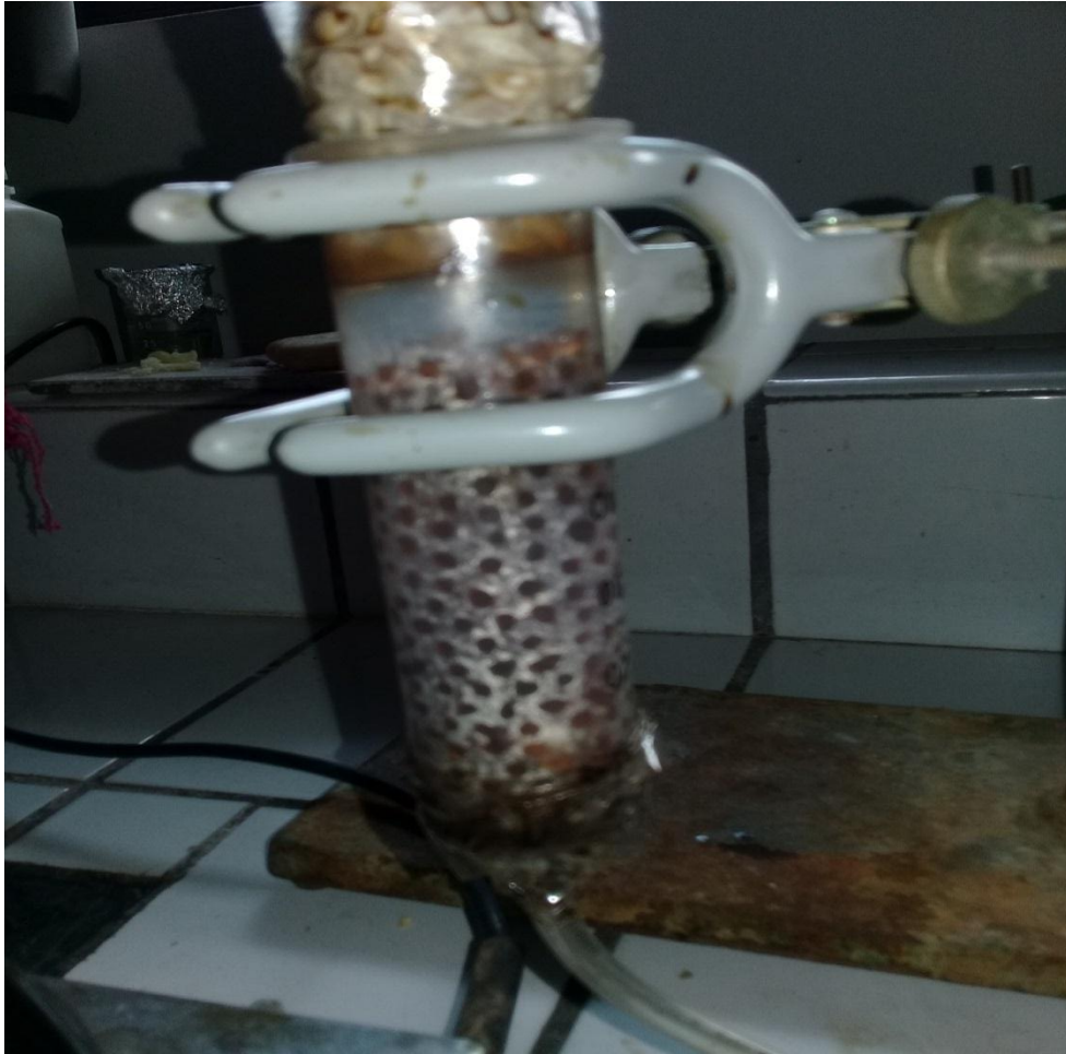
Figure IX-6: photo illustre le gonflement de des billes de AS/AP
