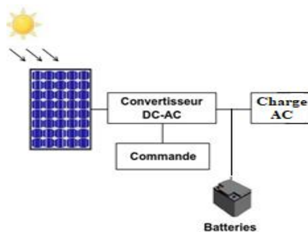
Figure 3: Système photovoltaïque autonome avec une charge continue
