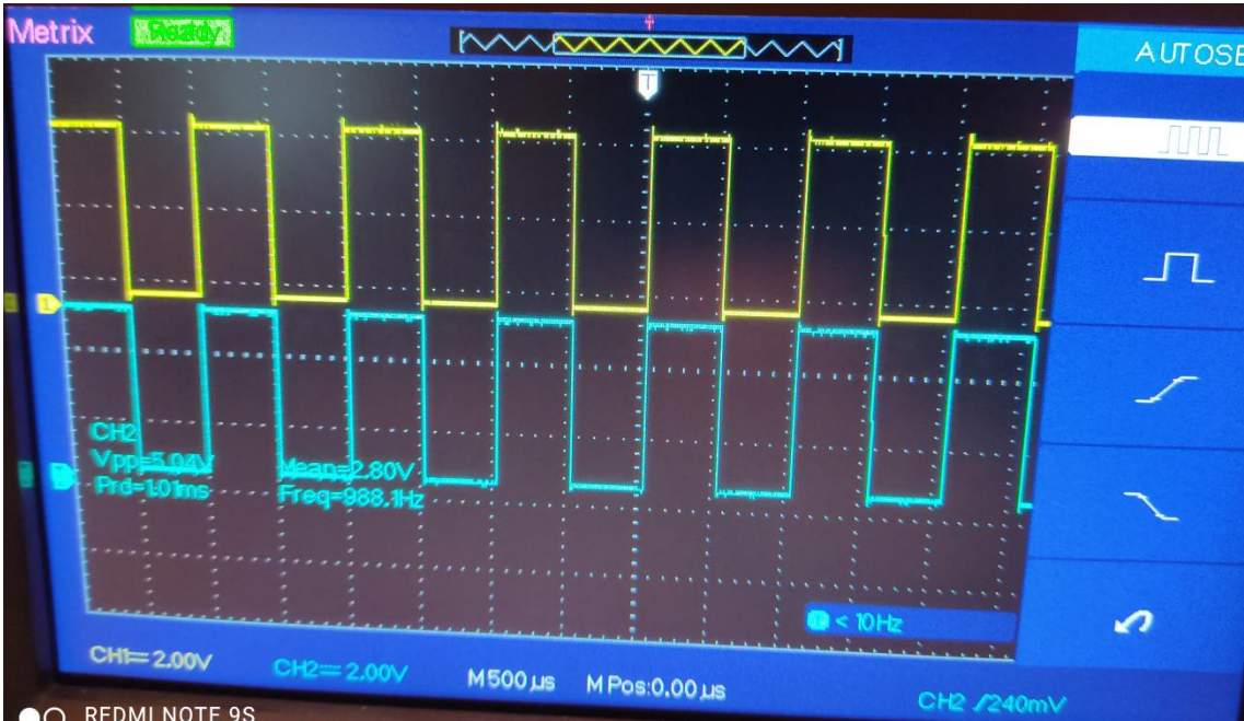
Figure 78 : Tensions de commandes générées par l'optocoupleur
