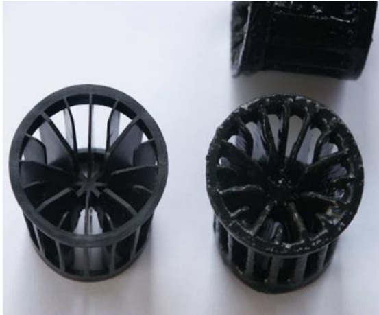
Figure 5: Supports mobiles avant et après formation du biofilm (Moletta, 2002)
