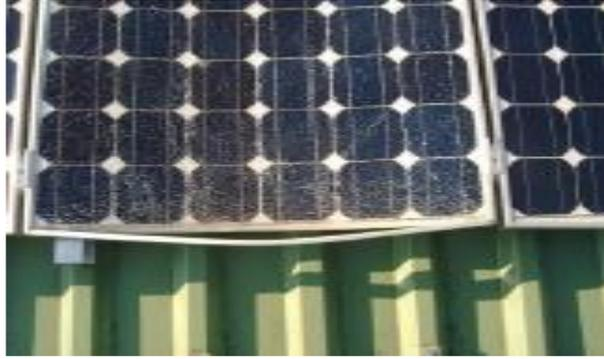
Figure 3. 3 : Dommages causés au cadre de module PV par la charge de la neige [60]
