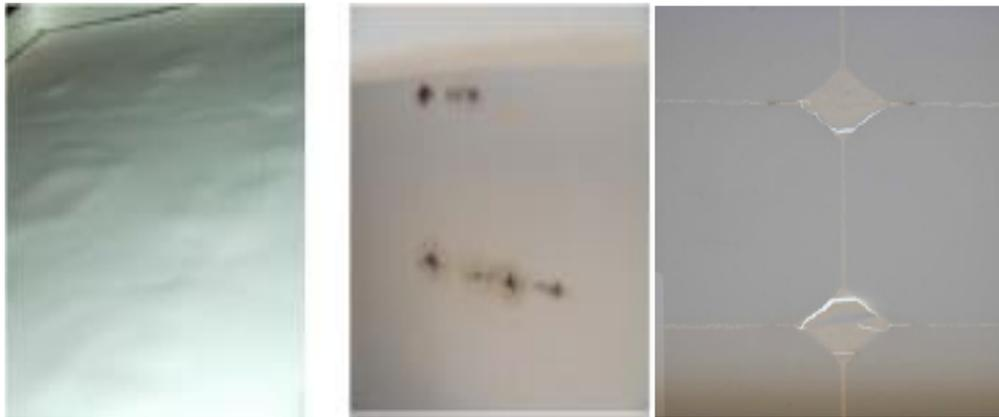
Figure 3. 4 : La délamination, marques de brûlure et des fissures sur l'encapsulant (la plaque arrière) des modules PV [69]
