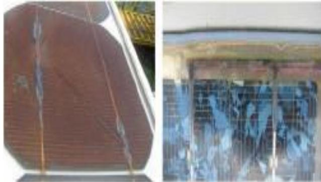
Figure 3. 7 : Exemple de corrosion des barres et des rubans d'interconnexion observée dans différents modules [75]
