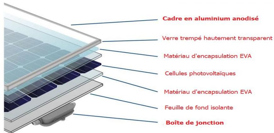
Figure 3. 2 : Composition d'un module PV standard
