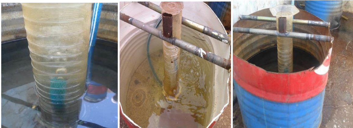
Photo 7 : Mesure de volume du biogaz par méthode déplacement d'eau
