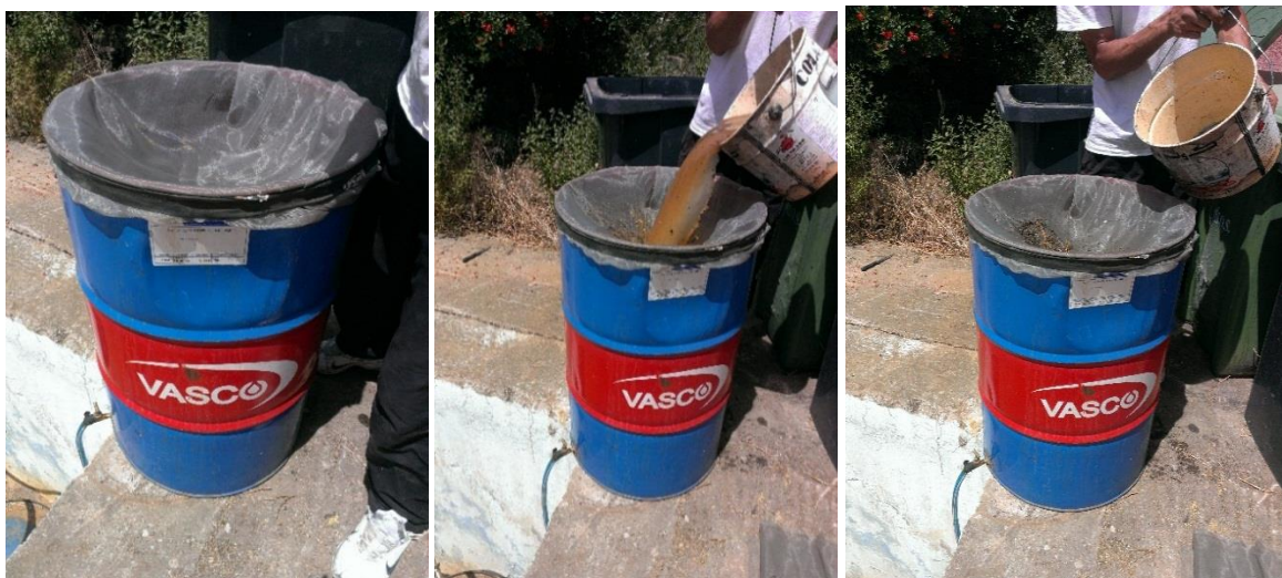
Photo 8 : Filtration des lixiviats bruts avant de passer dans le réacteur
