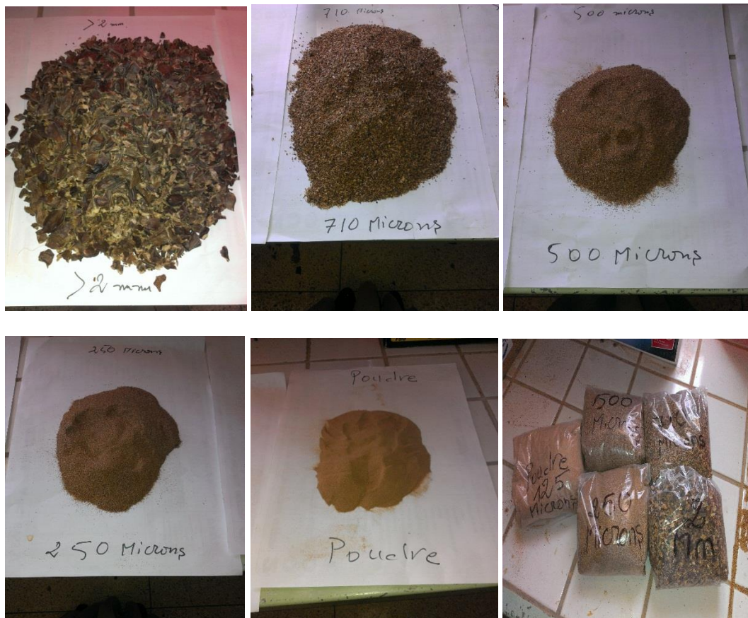
Photo 13 : Les classe granulométriques de la caroube utilisé dans le traitement des lixiviats
