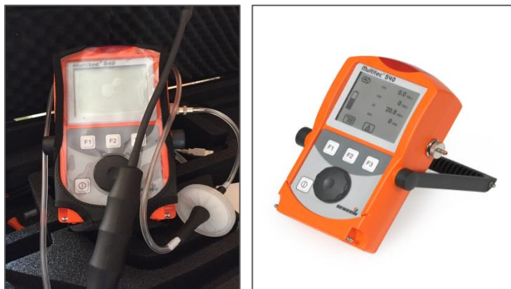
Photo 2 : Analyseur portable du Biogaz (MULTETEC 541)
