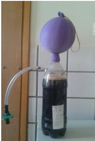
Figure 5 : Schéma du bioréacteur discontinu batch avec le dispositif de mesure du biogaz A : analyseur portable de biogaz ; R: Réacteur ; B: ballon de stockage de biogaz ; C,T: dispositif de mesure quantitatif de biogaz.
