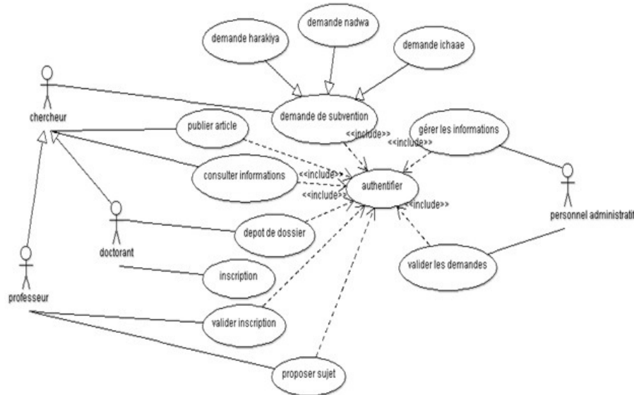
FIGURE 3.3 – Diagramme de cas d'utilisation de l'acteur chercheur.
