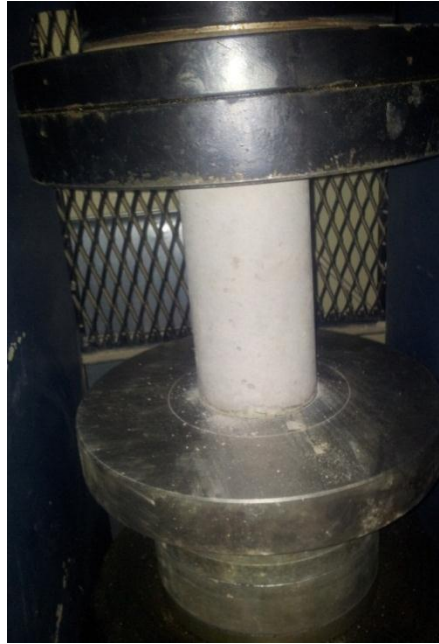
Figure 25: Essais de résistance mécanique en compression sur une éprouvette de béton
