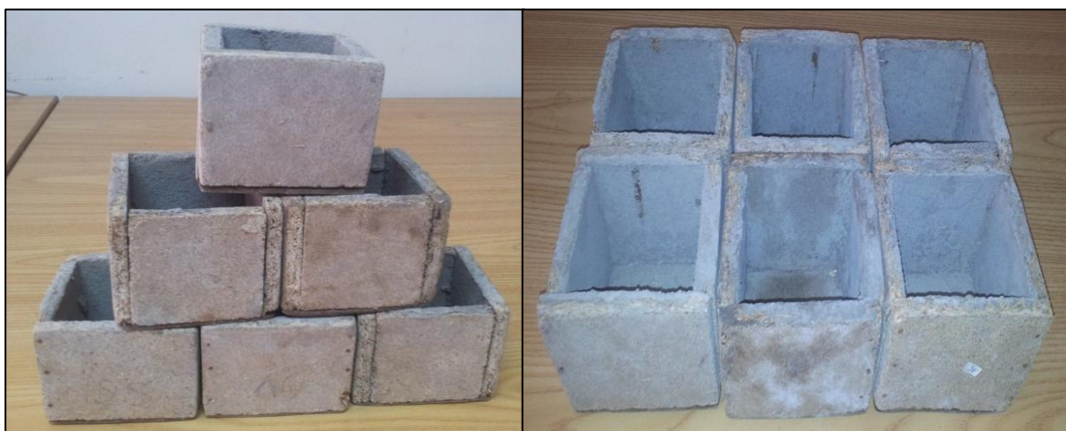
Figure 20: Moules utilisés pour la préparation des éprouvettes de mortier de 10 \times 10 \times 10 \text{ cm}^3
