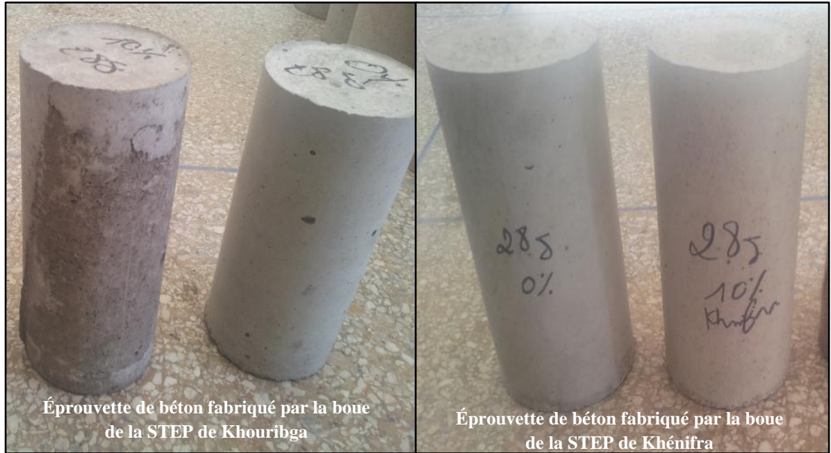
Figure 56: Éprouvette de béton fabriquée par les cendres des boues étudiées et éprouvette de témoin
