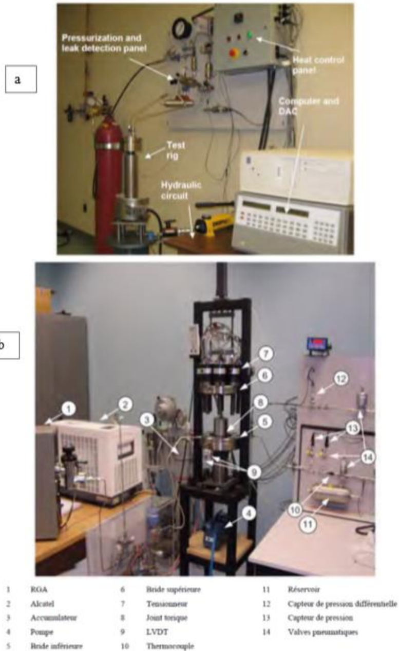
Figure I.21: Test standard utilisé par Grine [33] pour caractériser le paramètre poreux du joint. (a) UGR et (b) ROTT
