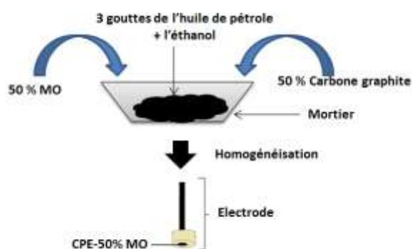
Fig. 15. Procédure de préparation de l'électrode modifiée (CPE-MO). MO= Molécule organique
