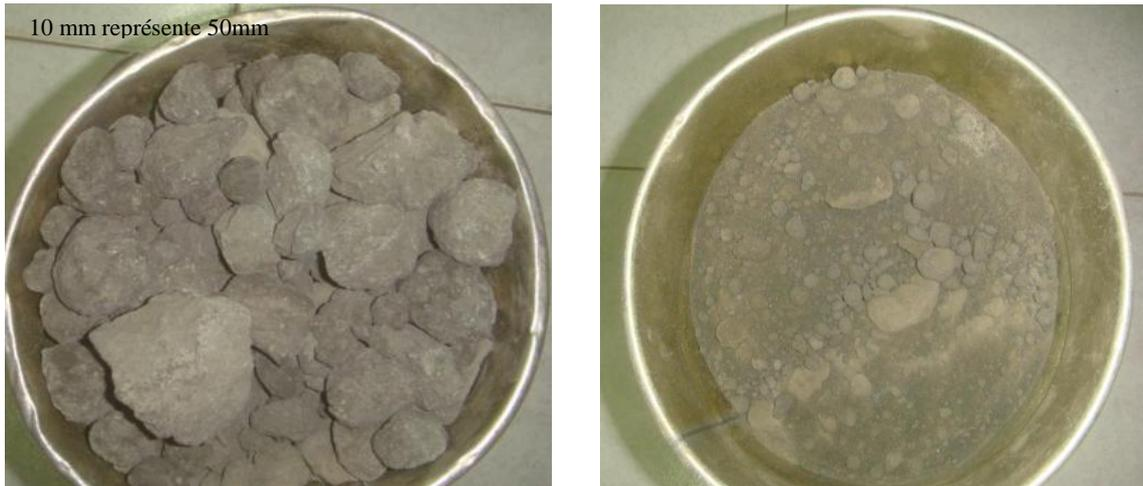
Clinker granulé (produit par la bauxite)      Clinker poussiéreux (produit par le machfer+ CV)
