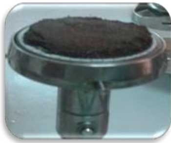
Figure 53 : Filtration de la suspension du sol
