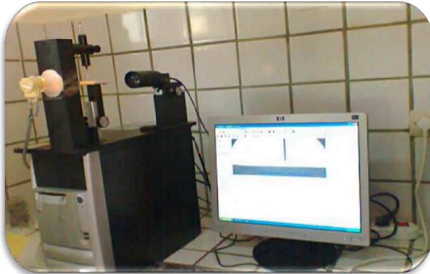
Figure 33 : Goniomètre (dispositif) de la mesure de l'angle de contact
